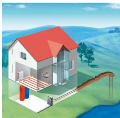
Figura 4.4: Sonda geotermica (immagine: BKW FMB Energie SA)
